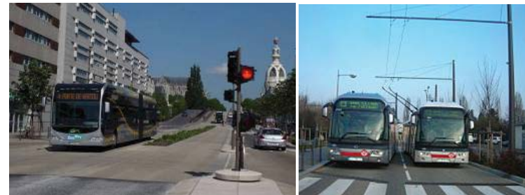
Mode BHNS (Bus à Haut Niveau de Service ou Bus en Site Propre) en mode thermique (Nantes) ou électrique (Lyon)
